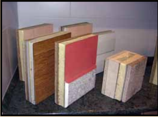
Panel sándwich prefabricado 40mm (chapa + aislante + chapa)
